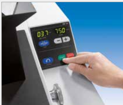
Ajuste digital de la velocidad, indicación digital de la abertura de salida
