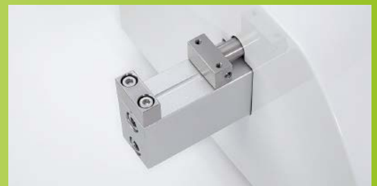
Una cuña asegura la alineación correcta de la muestra
