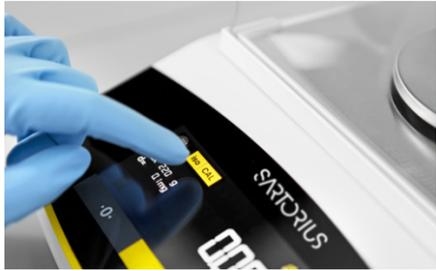
**Tecnología isoCAL (calibración y ajuste interno) que ofrece total garantía de precisión en los resultados de pesaje**
